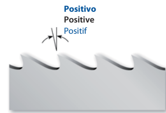
Geometría del filo de corte trapezoidal Trapezoid Cutting Blade Geometry Géométrie du filet de coupe trapézoïdal
